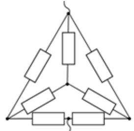
**10.2. Звезда в треугольнике.** Определите сопротивление цепи, состоящей из 7 одинаковых резисторов сопротивлением  $R = 8$  Ом.
