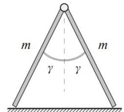
**10.5. Шпагат-2.** На рисунке изображена конструкция, состоящая из соединённых шарнирно одинаковых однородных досок, наклоненных под углами  $\gamma$  к вертикали. Если такую конструкцию поставить на абсолютно гладкую поверхность, то части конструкции будут разъезжаться. В тот момент, когда угол между досками увеличился вдвое (стал  $4\gamma$ ), скорость шарнира стала равна  $\vartheta$ . Определите скорости центров  $v_0$  и нижних точек досок  $u$ . Укажите их направления.
